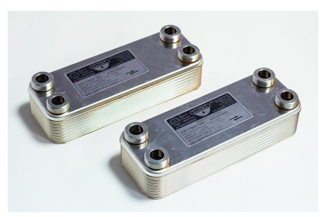
Пластины соединены способом пайки. Материал пластин-нержавеющая сталь AISI 316, материал припоя – медь. Преимущества такого теплообменника в том, что высокая эффективность теплопередачи позволяет делать его компактным и экономить пространство.
